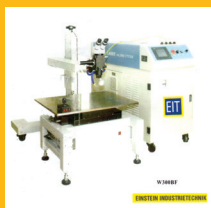
LASER WELDING MACHING EIT- HANS รุ่นไฟเบอร์ เลเซอร์ 300 วัตต์
